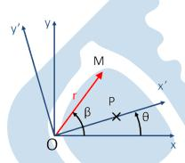
Remarque : s'il peut s'avérer difficile de mémoriser le signe à mettre devant  $sin(\theta)$  (+ dans une ligne et – dans l'autre) l'astuce consiste à considérer un point particulier (tel que P sur la figure) avec y=0 ou y'=0 selon les besoins et de vérifier alors sur la figure le signe de la coordonnée voulue.
